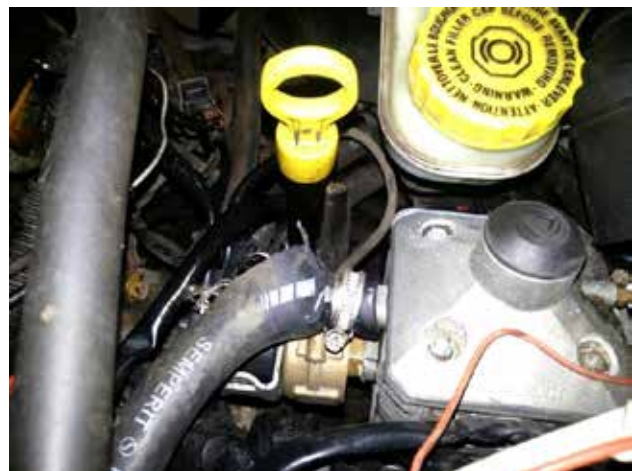
Рис. 2. Розрив газового шлангу через високий тиск у магістралі після редуктора
